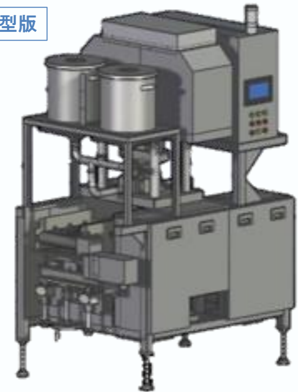
NL-IJ30012 コンベア幅 300mm ノズル数 12本
