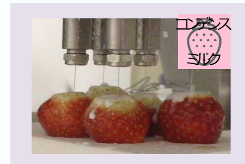
NL-IJ30012 コンベア幅 300mm ノズル数 12本
